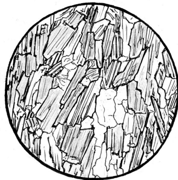
нематобластовая структура, есть разновидность — фибробластовая (с игольчатыми кристаллами)
